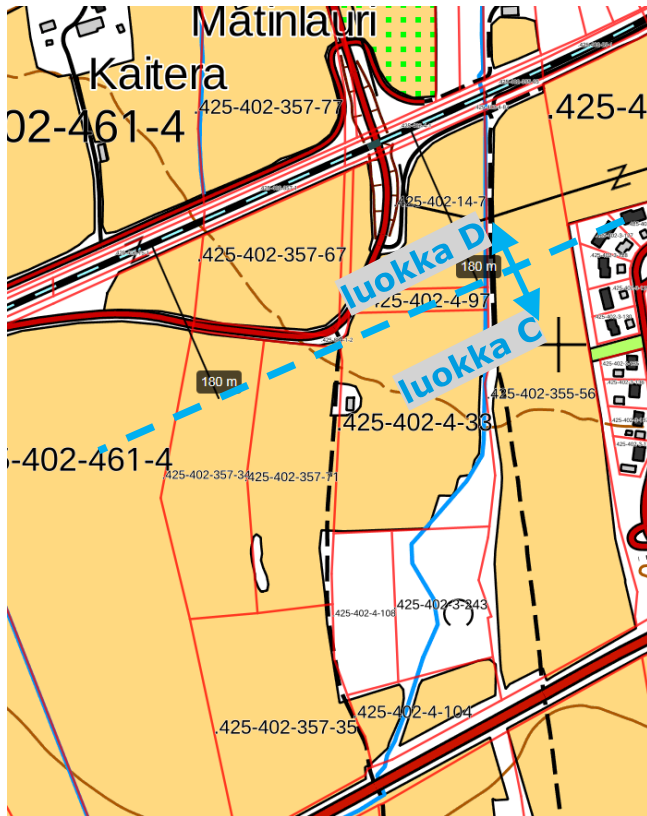
Kuva 4.5. Arvioitu värähtelyluokkien C ja D raja 180 m päässä radasta. Tässä oletetaan, että rakenteiden resonanssia ei esiinny, ja tärinää ei torjuta esim. tärinänvaimennusseinillä. Karttapohja: Maanmittauslaitos 2018.
