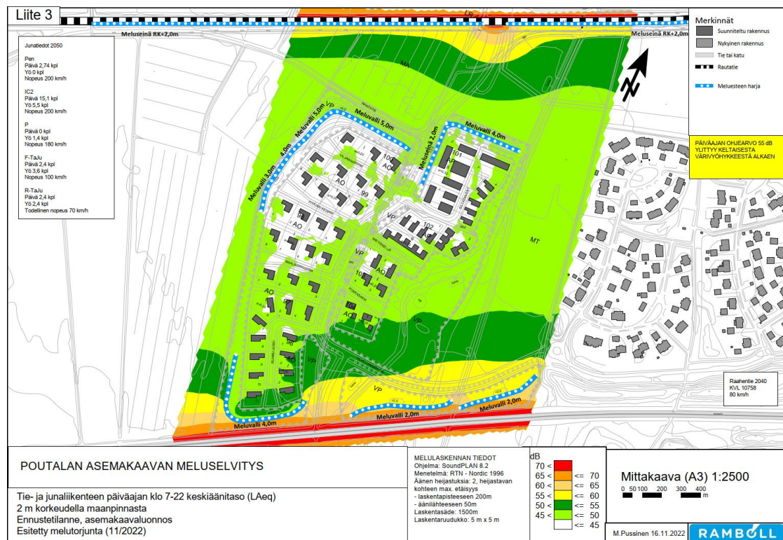
Kuva 7 Päiväaikaiset keskiäänitasot kaavaehdotuksen mukaisella suunnitteluratkaisulla ja melusuojuuksella. Päiväajan melun ohjearvo 55 dB ylittyy keltaisesta väriyöhykkeestä alkaen.
